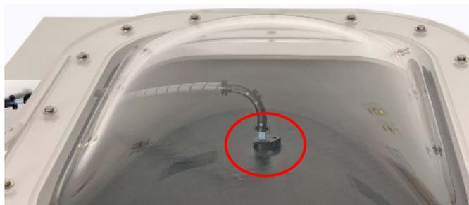
Abb. 6: Ratschenklemme an der Oberseite der Messkammer
