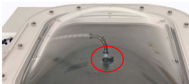
Abb. 6: Ratschenklemme an der Oberseite der Messkammer
