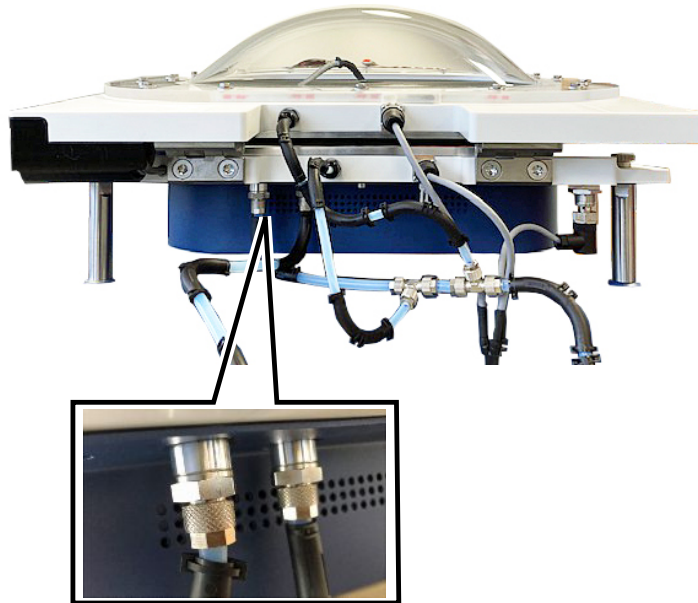
Abb. 7: Schlauchverschraubung unterer Membranträger
