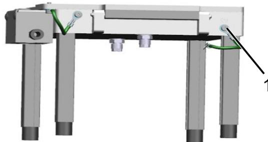
1 Anschluss für Potenzialausgleich an der Rückseite der Prüfkammer
