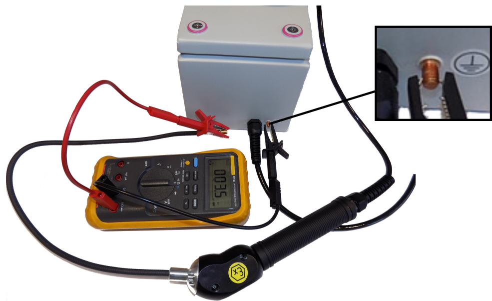
Abb. 3: Prüfen der Verbindung zwischen Kapillarfilter und Erde
