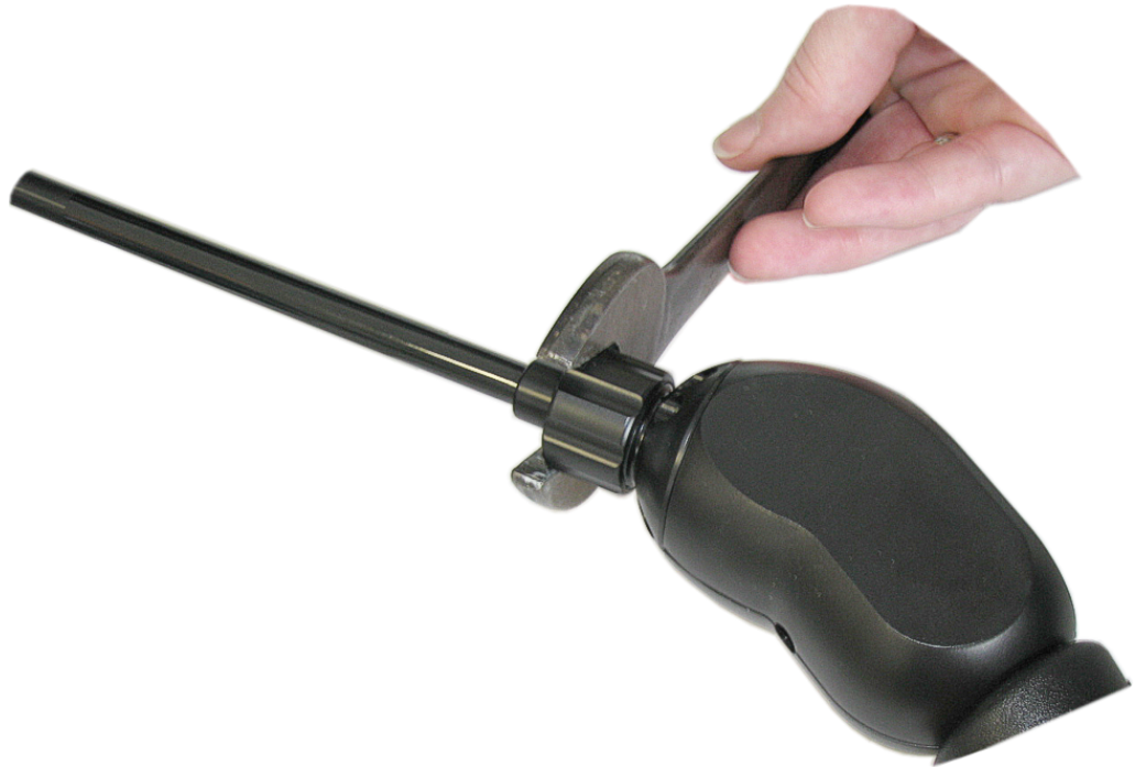
Abb. 12: Hutmutter der Schnüffelspitze lösen
