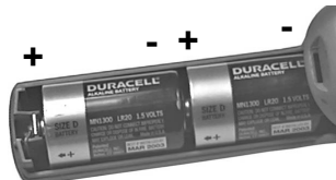
Figure 7. Installation adéquate des piles alcalines
