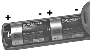
Afbeelding 5. Correct geïnstalleerde alkalinebatterijen
