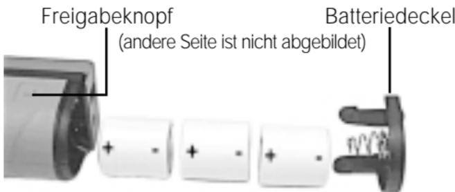
Vor dem Einsetzen neuer Akkus zuerst das im Akkufach befindliche Polaritätsschild beachten und den ersten Akku mit seiner positiven Seite (Knopfseite) in das Akkufach einführen. Wenn die Antriebszellen eingelegt sind, legen Sie den Deckel wieder genau zwischen die beiden Laschen und schieben Sie ihn gerade hinein, bis er einschnappt.
