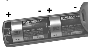
Figura 7. Batterie alcaline installate correttamente
