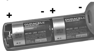
Figura 3. Pilas alcalinas debidamente instaladas
