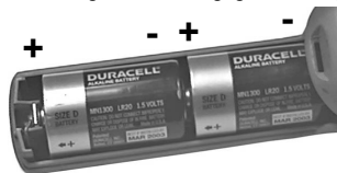
Abbildung 5. Ordnungsgemäß eingelegte Alkalibatterien
