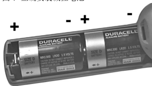
图1 正确安装碱性电池
