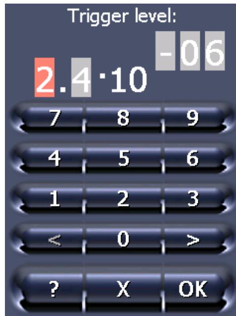
Abb. 14: Menü Trigger, Numerisches Tastenfeld
