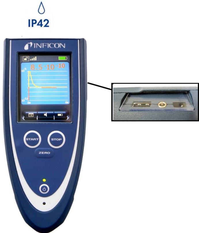
Abb. 6: RC1000WL: Seitliche Anschlüsse mit transparenter Abdeckung
