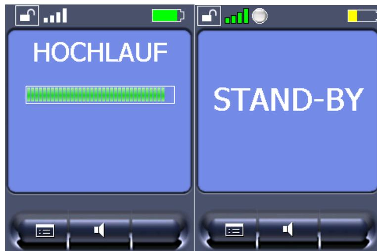
Abb. 27: Zustandsanzeigen Hochlauf und Stand-By
