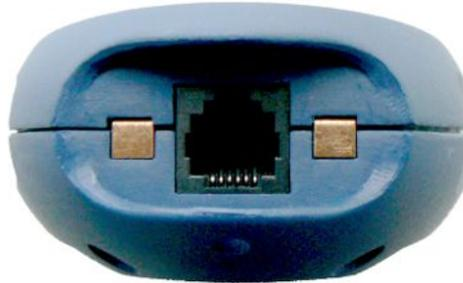
Abb. 4: RJ25-Buchse an der Unterseite einer Fernbedienung
