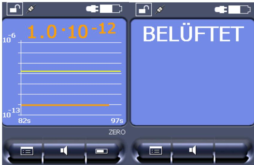
Abb. 29: Zustandsanzeigen Messen (Verlaufdiagramm) und Belüftet
