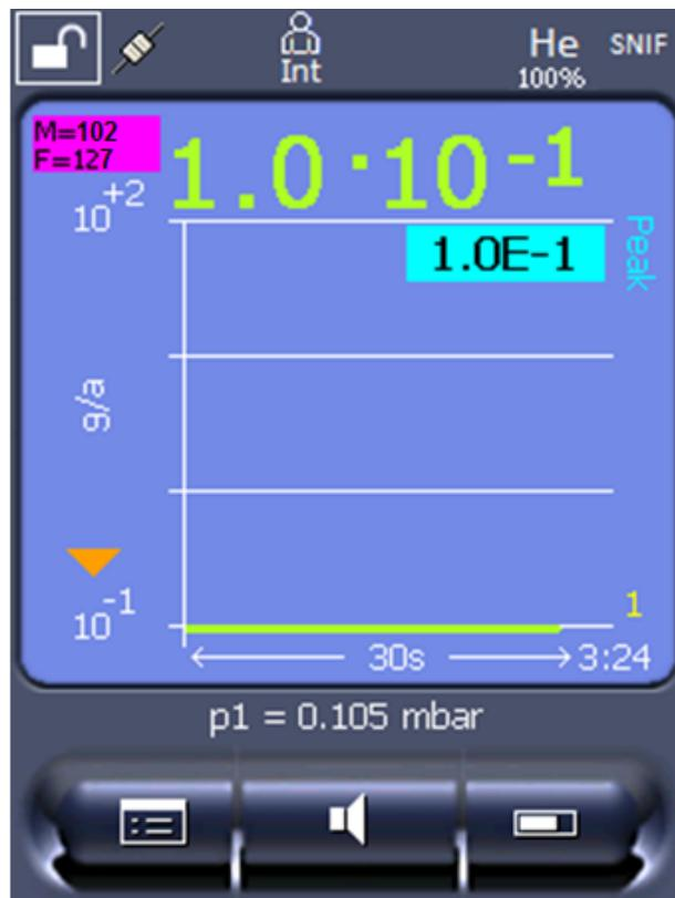
Abb. 4: Links oben: Anzeige der molaren Masse (102) und des Äquivalenzfaktors (127)
