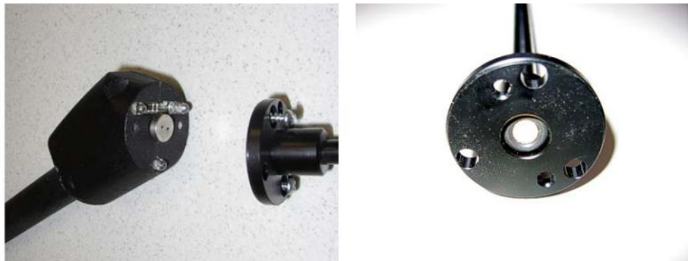
Abb. 19: Sinterfilter im Schnüffel-Handgriff
