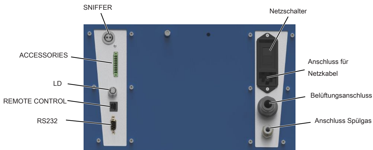
Abb. 6: Anschlüsse für Zubehör und Steuersignale
