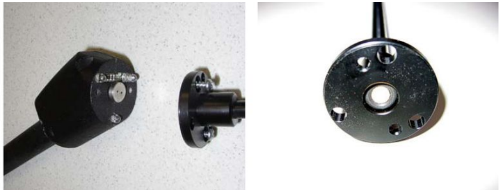
Abb. 19: Sinterfilter im Schnüffel-Handgriff
