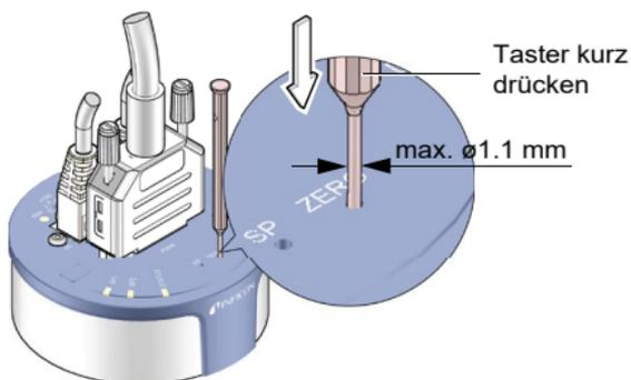
... beim Remote Zero am Pin 10 die Versorgungsspannung anlegen (Impulse  $\rightarrow$  10).
