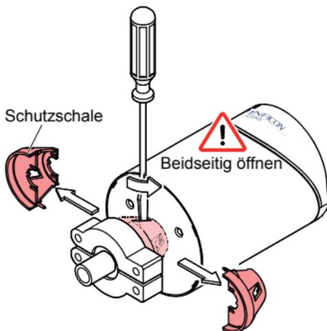
**2** Messröhre vom Vakuumsystem demontieren und Schutzkappe aufsetzen.
