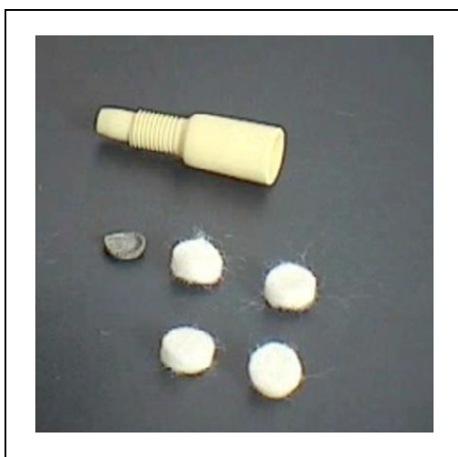
Abb. 8-10 alte und neue Filterpads
