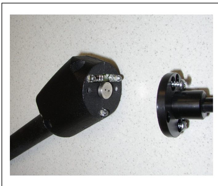
Abb. 8-11 Abnahme der Schnüffelspitze
