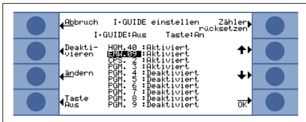
Abb. 4-18 Einstellen des I•Guide-Modus
