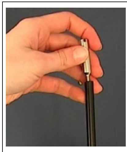
Abb. 1-7 Installation der Wasserschutzspitze
