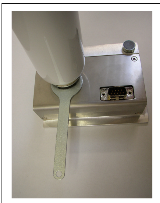
Abb. 8-18 Installieren des Gasspeichers
