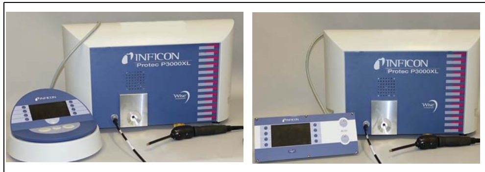
Abb. 6 Der Protec P3000XL mit externer Anzeigeeinheit für: (a) als Tischgerät (links), (b) für Gestellmontage (rechts)
