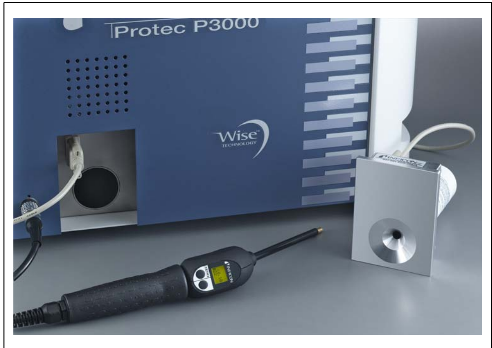
Abb. 15 PRO-Check Referenzleck zur Verwendung an anderer Stelle aus dem Hauptgerät herausgenommen
