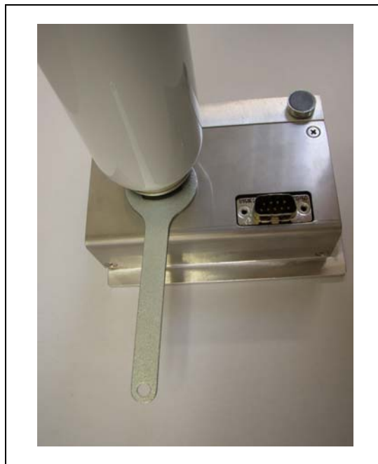
Abb. 87 Installieren des Gasspeichers
