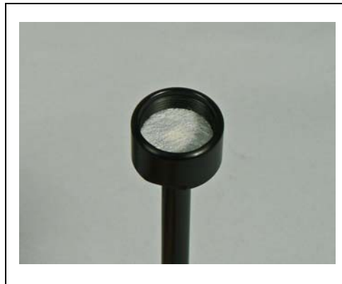
Abb. 80 Filterstück in Hutmutter
