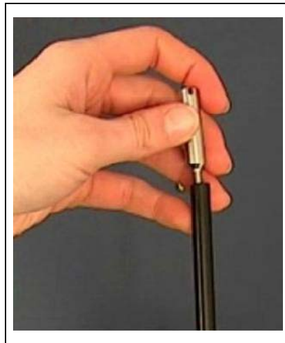
Abb. 4 Installation der Wasserschutzspitze
