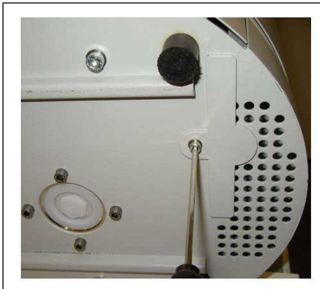
Abb. 69 Die Halterung für das Luftfilter des Lecksuchgeräts
