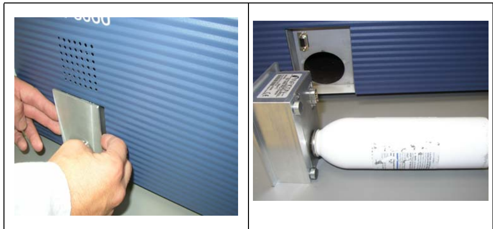
Abb. 85 Entnahme des PRO-Check Referenzlecks aus dem Hauptgerät
