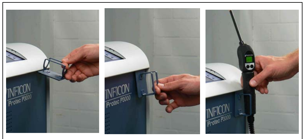
Abb. 8 Installation des Schnüffelleitungshalters
