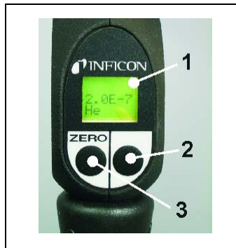
Abb. 12 SL3000(XL) Schnüffelleitung mit Sondenanzeige
