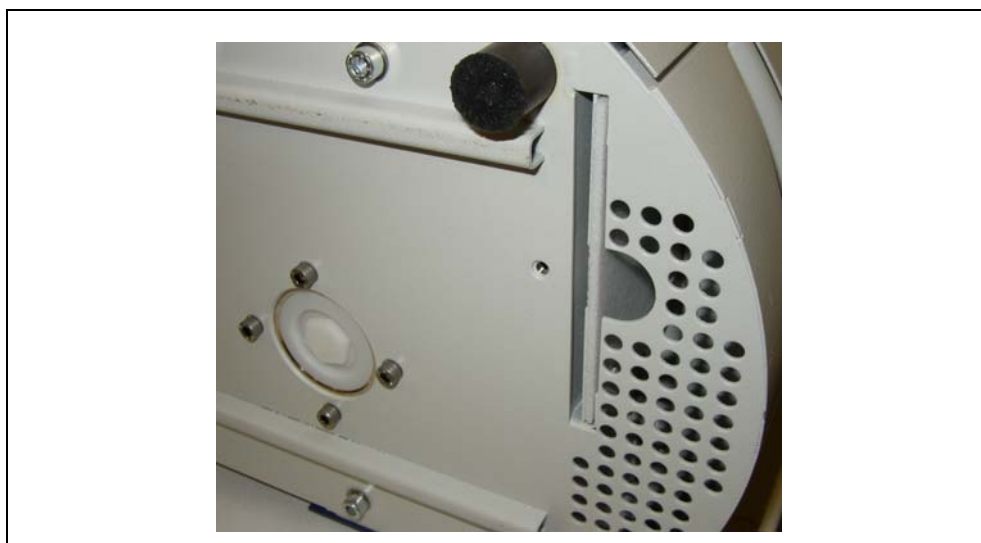
Abb. 70 Entfernen Sie den Luftfilter
