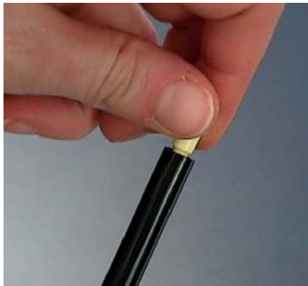
Abb. 73 Den Kapillarfilter herausschrauben
