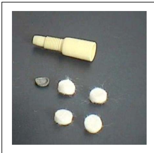
Abb. 75 Altes und neues Filzfilter
