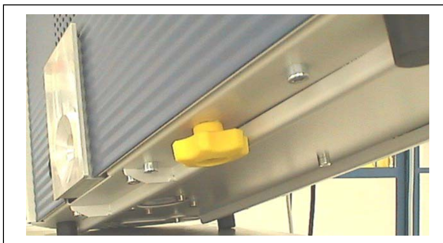
Abb. 3 Entfernen der Transportsicherung vor Inbetriebnahme
