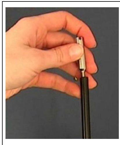
Abb. 3 Installation der Wasserschutzspitze
