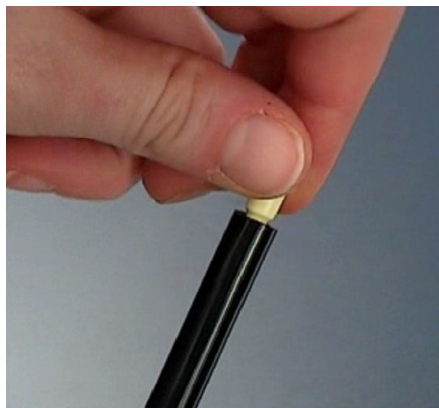
Abb. 72 Den Kapillarfilter herausschrauben
