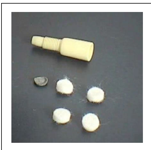
Abb. 74 Alter und neuer Filzfilter
