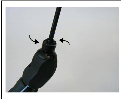
Abb. 77 Abnehmen von Handgriff und Schnüffelspitze
