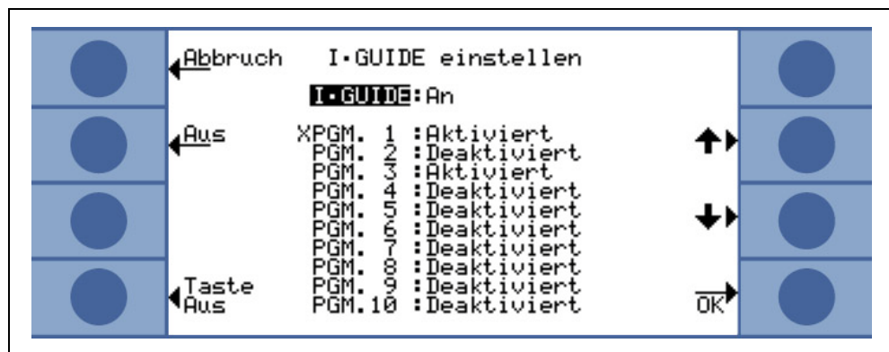
Abb. 56 Einstellen des I•Guide-Modus
