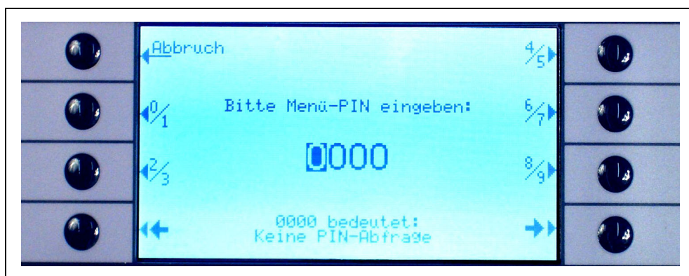
Abb. 53 Einstellen einer Menü-PIN für den Schutz der Parameter
