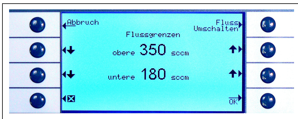
Abb. 49 Die Durchflussgrenzen für die SL3000 Schnüffelleitung ändern
