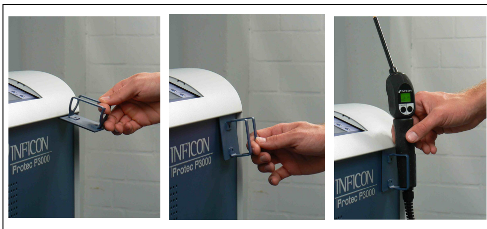
Abb. 7 Installation des Schnüffelleitungshalters
