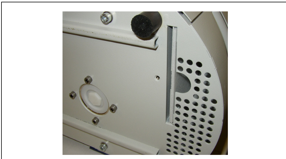
Abb. 70 Entfernen Sie den Luftfilter
