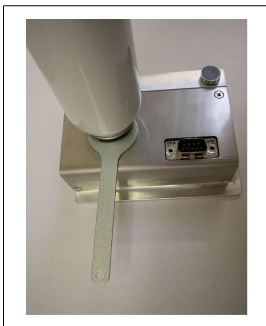
Abb. 86 Installieren des Gasspeichers
