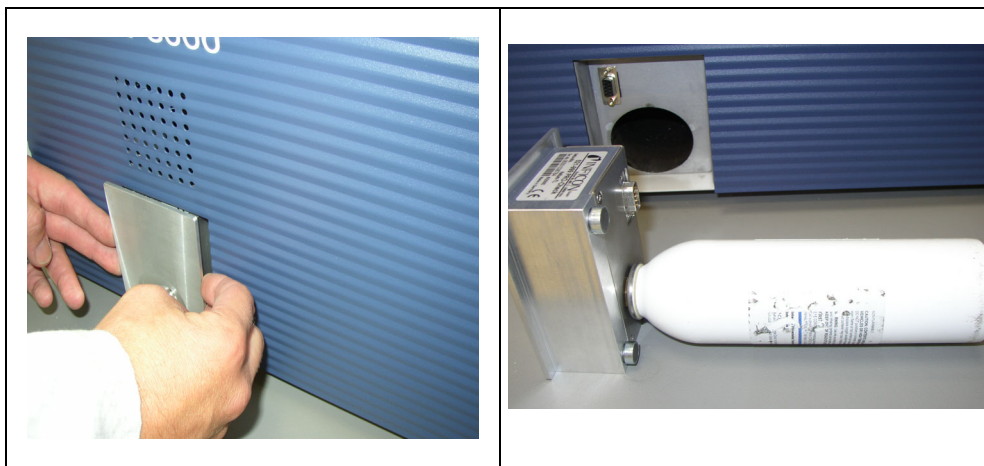
Abb. 84 Entnahme des PRO-Check Referenzlecks aus dem Hauptgerät
