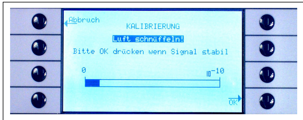
Abb. 36 Aufforderung, während der externen Kalibrierung Luft zu schnüffeln
