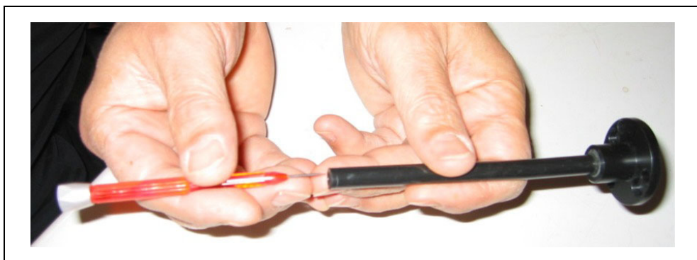
Abb. 82 Herausschieben des Stahlkapillars
