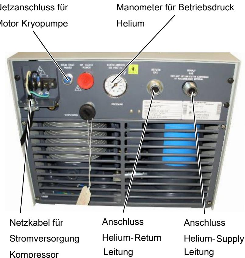
Abb. 8: Anschlüsse am Kryopumpen-Kompressor
