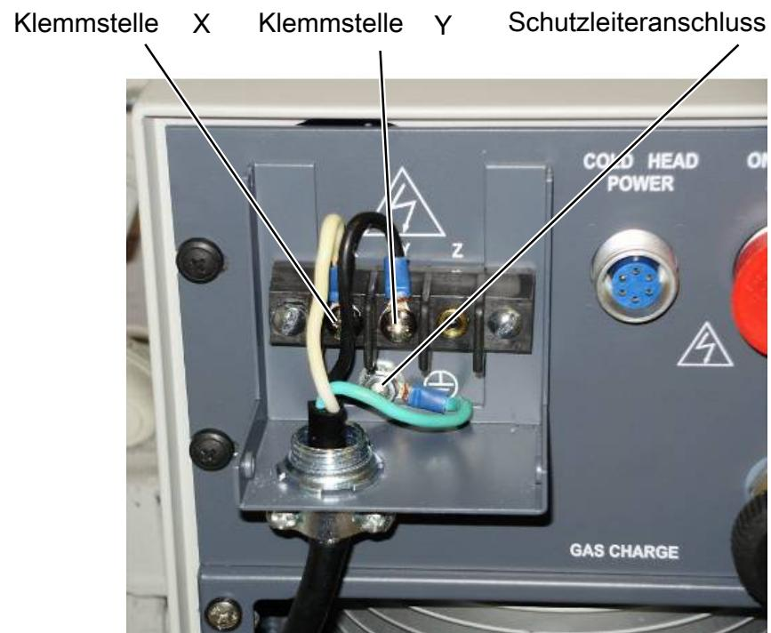
Abb. 10: Kompressor: Klemmstellen für den Anschluss des Netzkabels
