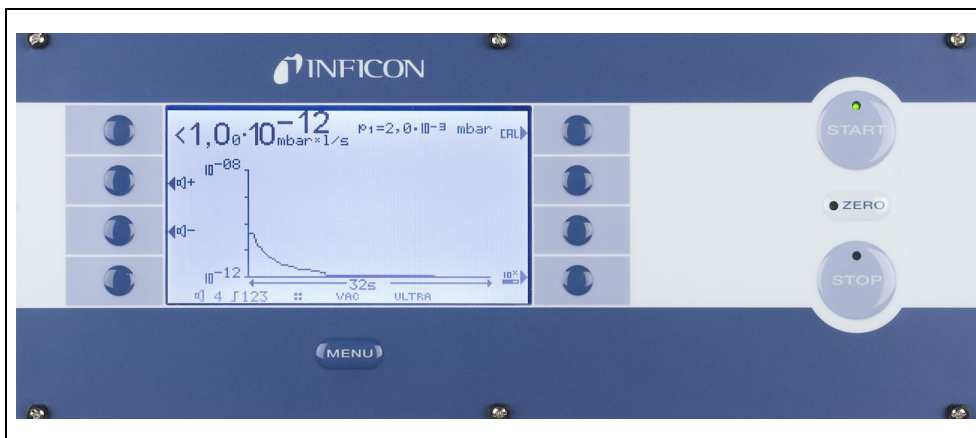
Abb. 3-6 Gerätebedienung für den Schaltschrankeinbau
