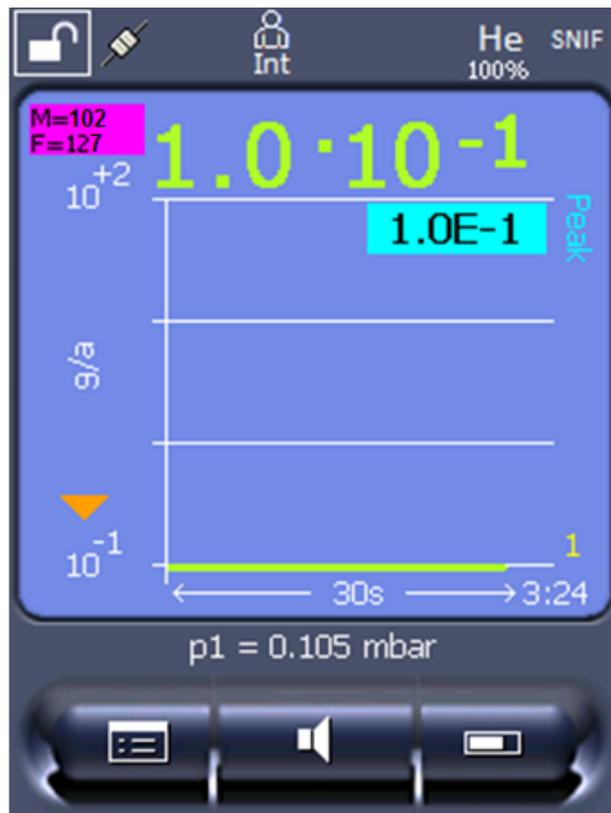
Abb. 24: Links oben: Anzeige der molaren Masse (102) und des Äquivalenzfaktors (127)
