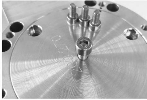
4 Nutzen Sie die Schraube zum Anheben des Verschlussdeckels.
