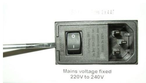
Abb. 50: Deckel nach rechts aufhebeln
