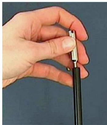
Abb. 8: Wasserschutzspitze festschrauben
