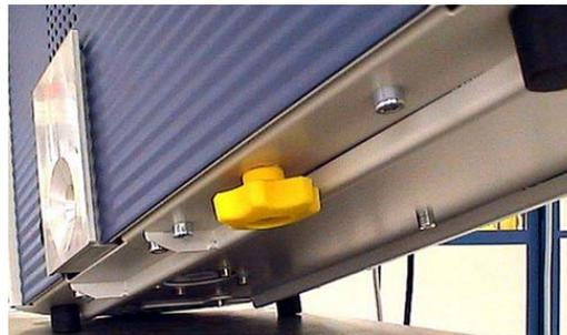
Abb. 5: Gelbe Transportsicherung vor Inbetriebnahme herausschrauben
