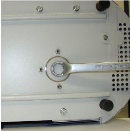
Abb. 47: Verschluss des Betriebsmittelspeichers
