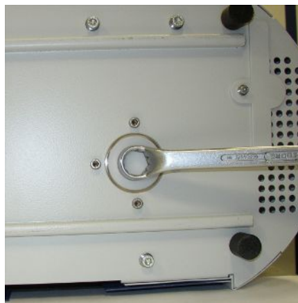
Abb. 48: Verschluss des Betriebsmittelspeichers
