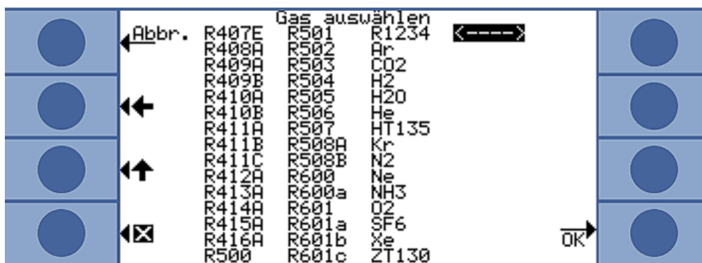
Abb. 28: Letzter Eintrag schaltet die Gas-Äquivalent-Funktion aus
