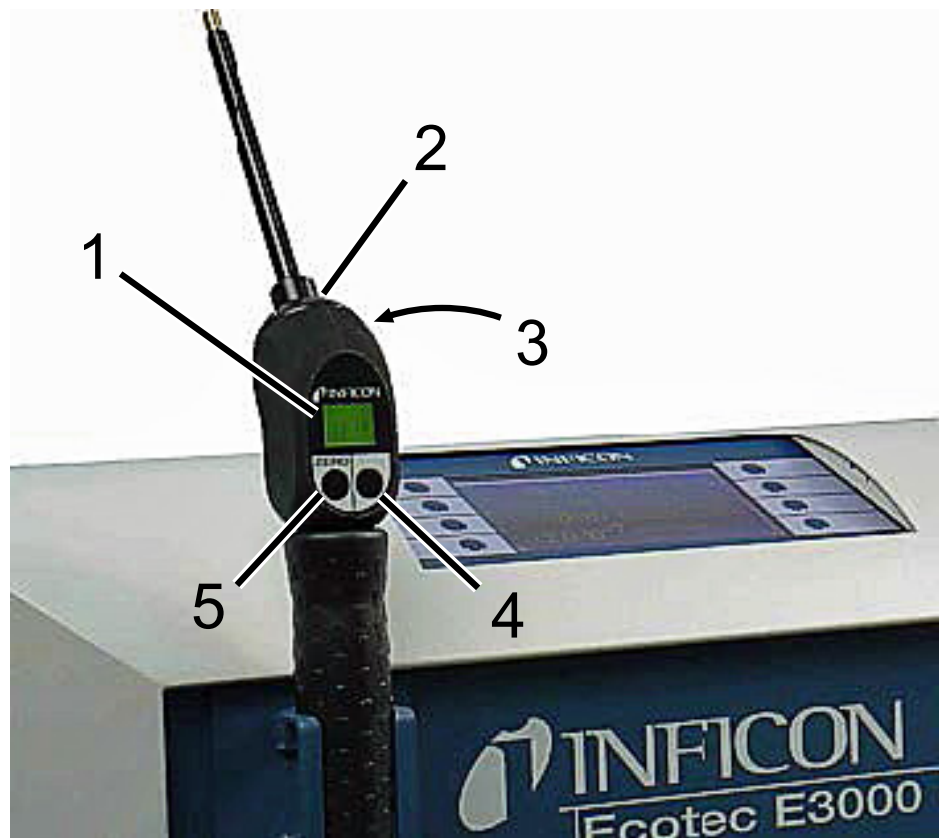
Abb. 4: Schnüffel-Handgriff: Anzeige und Funktionen
