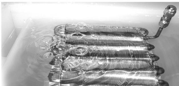
In condizioni ideali, raramente ottenibili in un laboratorio, con un tasso di perdita di 0,06 sccm si forma una bolla al secondo. Tuttavia, con un tasso di perdita di 0,006 sccm servono già 30 secondi affinché si formi una sola piccola bolla.
