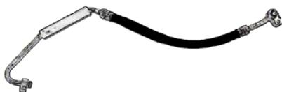
Schläuche für mobile Klimaanlagen werden auf Leckraten im Bereich von 2 – 7 g/a Kältemittelverlust geprüft.
