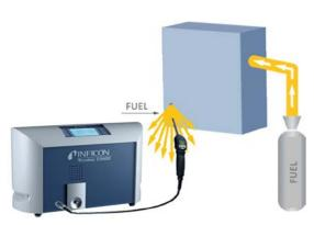
Bei der Endmontage werden die Anschlüsse von der Hochdruck-Kraftstoffpumpe an die Kraftstoffanlage mit einem Schnüffel-Lecksuchgerät direkt auf undichte Stellen geprüft.
