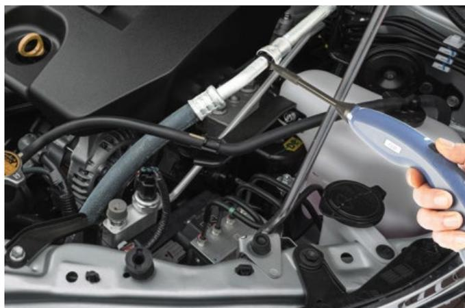
Der Schnüffelhandgriff des CO<sub>2</sub>-Lecksuchgerätes HLD6000 ist ergonomisch gestaltet und ermöglicht dadurch ein einfaches Handling.
