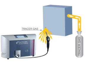
Der Kraftstoffkreislauf von Einspritzmotoren wird mittels Helium-Schnüffeltest geprüft.
