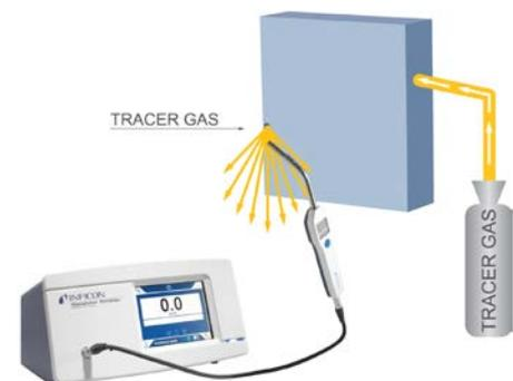
Die Kühlkreisläufe des Batteriepacks werden normalerweise mithilfe eines Schnüffelverfahrens getestet, wobei die undichte Stelle direkt in einem einzigen Verfahrensschritt lokalisiert wird.
