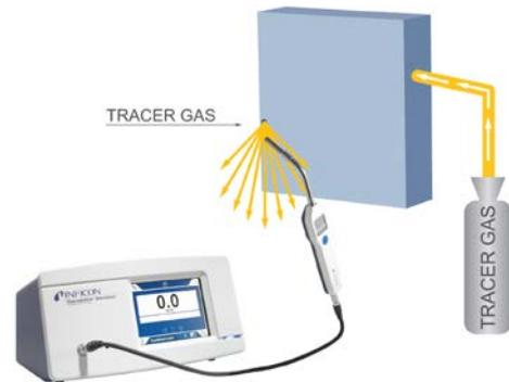
Für größere Batteriepacks oder für ein manuelles Verfahren wird ein Schnüffeltest mit Formiergas unter Verwendung des [Sensistor Sentrac-Wasserstoff-Lecksuchgeräts](#) empfohlen.
