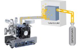
Mit Helium vorgefüllte Batterien werden üblicherweise mithilfe der Vakuum-Dichtheitsprüfung getestet. Dieses Verfahren ist weitverbreitet für prismatische Zellen. Das Gehäuse der Batteriezelle wird nur dann mit Elektrolyt gefüllt und letztlich versiegelt, wenn diese Dichtheitsprüfung erfolgreich bestanden wird. Diese Art der Vorprüfung kann nicht auf Pouchzellen angewendet werden.
