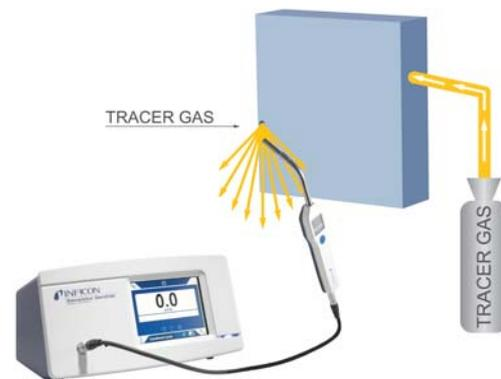
*Vormontierte Wasserstofftanks werden oft durch Wasserstoff-Schnüffeln getestet.*
