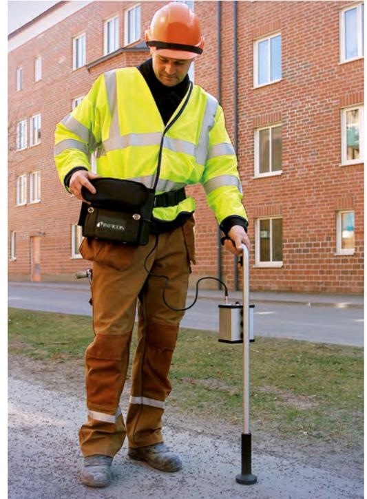
Funktionsumfang erleichtern die Wartung an Nachrichtenkabeln, die unterirdisch oder in Schutzrohren verlegt sind
