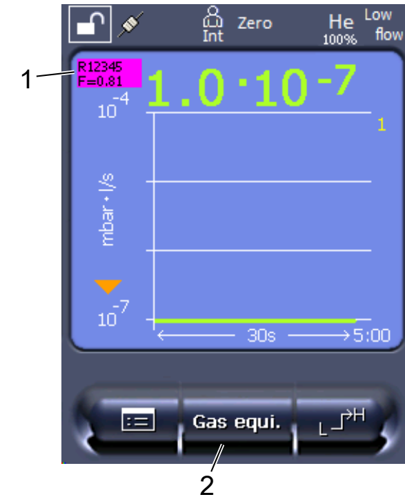
插图 17: 测量界面上显示等效漏率并设有收藏夹键
