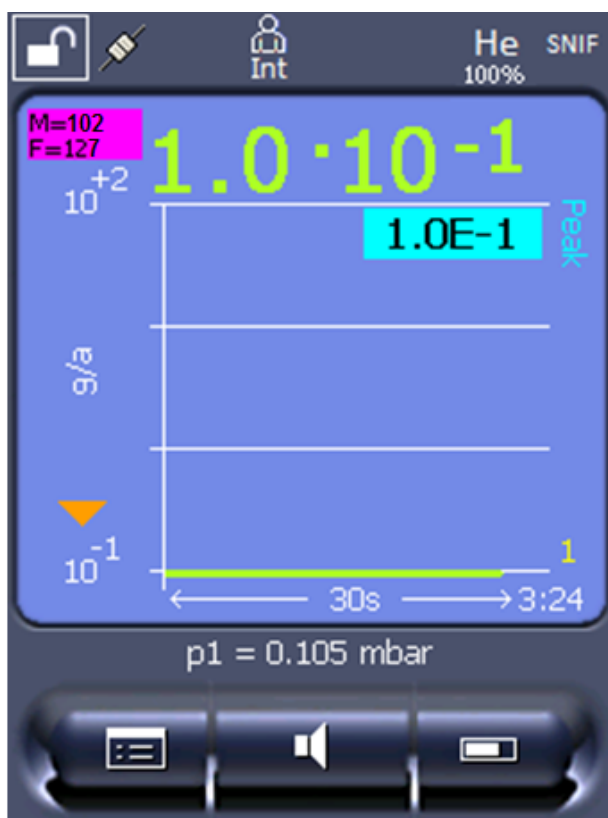
Rys. 18: W lewym górnym rogu: Wskazanie masy molowej (102) i współczynnika ekwiwalencji (127)
