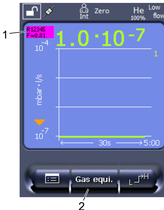
Obr. 17: Obrazovka měření se zobrazenou ekvivalentní mírou netěsnosti a nastaveným tlačítkem Favorité
