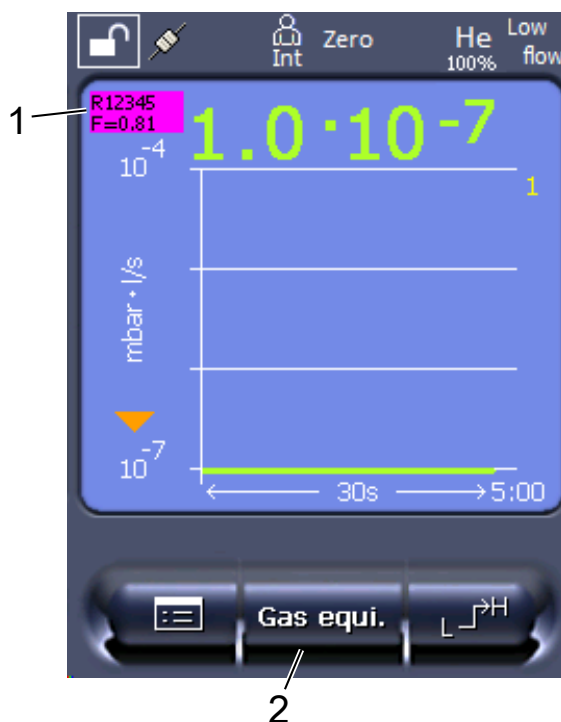
Fig. 17: Écran de mesure avec taux de fuite d'équivalence affiché et touche de favori activée
