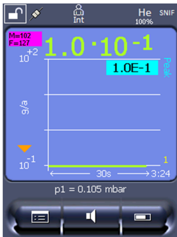
Fig. 18: Parte superior izquierda: visualización de la masa molar (102) y del factor de equivalencia (127)
