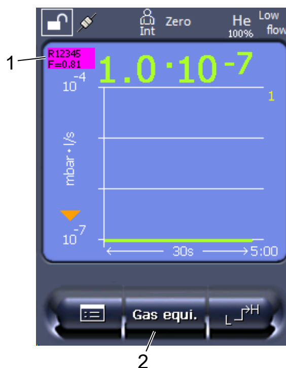
Fig. 17: Pantalla de medición con tasa de fuga equivalente visualizada y tecla de favoritos configurada
