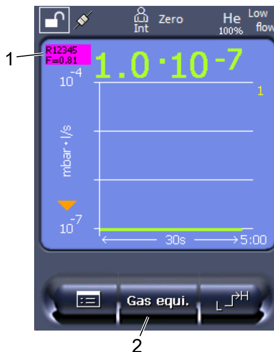
Fig. 17: Tela de medição com taxa de fuga de equivalência exibida e tecla de favoritos configurada
