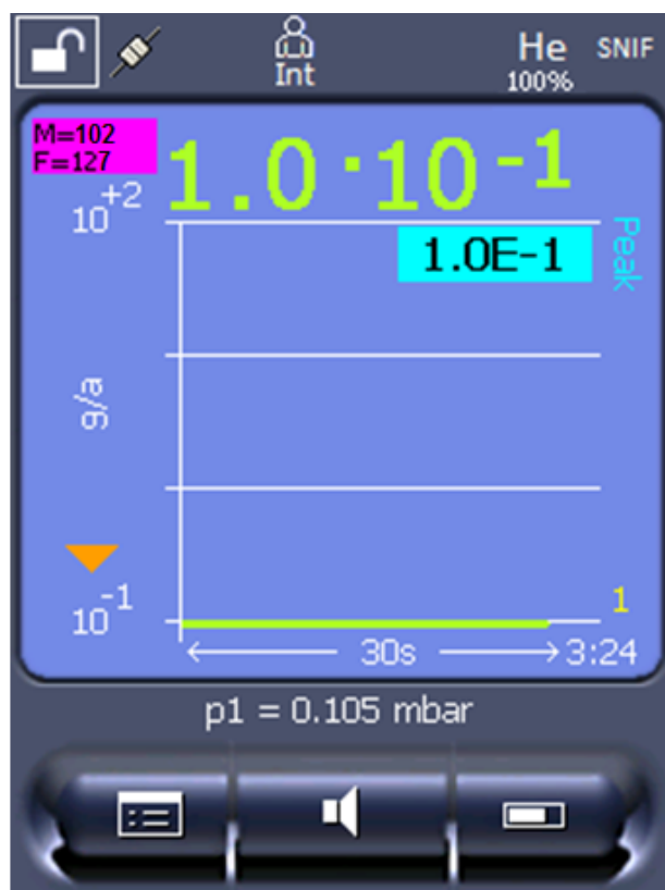
Fig. 18: Parte superior esquerda: Exibição da massa molar (102) e do fator de equivalência (127)
