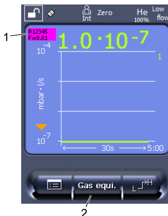
Fig. 14: Écran de mesure avec taux de fuite d'équivalence affiché et touche de favori activée
