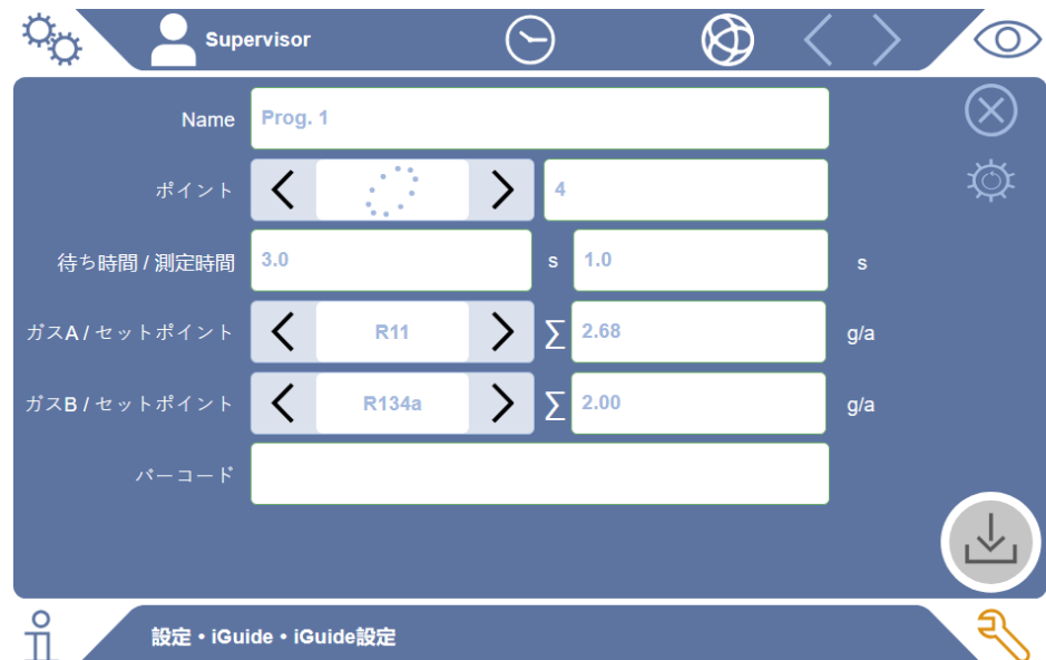
図 9: 「iGuide設定」ウィンドウにおけるiGuideプログラムの設定項目
