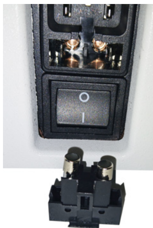
Fig. 12: Tampa com fusíveis
