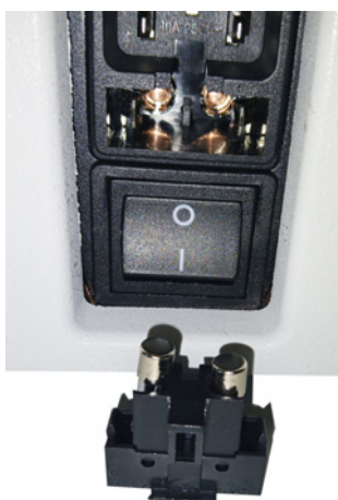
Fig. 12: Cubierta con fusibles
