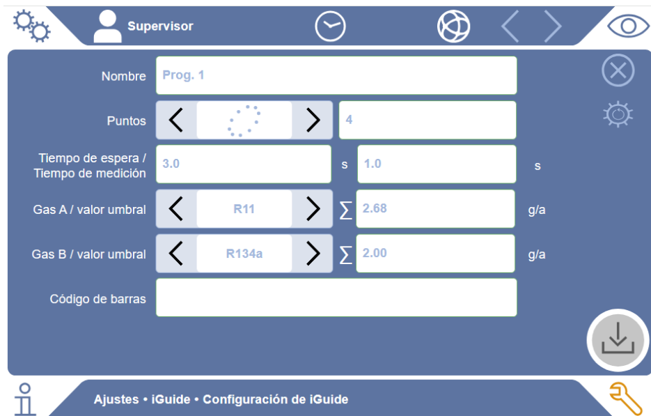
Fig. 9: Opciones de configuración de un programa iGuide en la ventana «Ajustes de iGuide»
