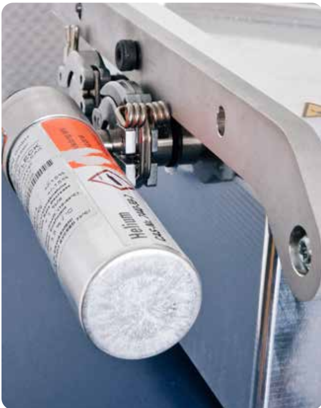
Fuga calibrada con conexión a la cámara de pruebas de fugas
