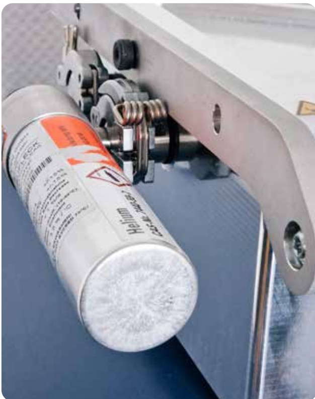
Prüfleck an der Prüfkammer
