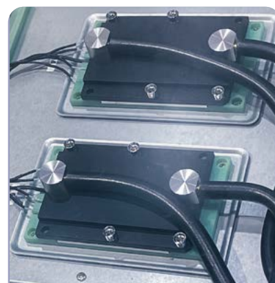
直触芯片冷却设计的原型。需检测泄漏的组件包括冷板、管道和快速接头等。
