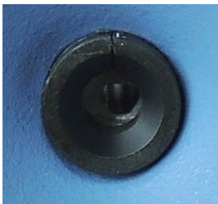
Fig. 6: Applicazione dell'anello di centraggio
