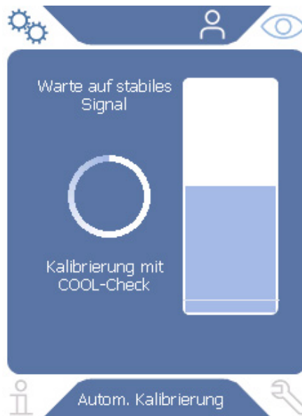
Abb. 9: Anzeige beim internen Kalibrieren
