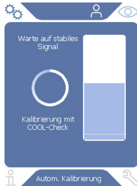
Abb. 8: Anzeige beim internen Kalibrieren
