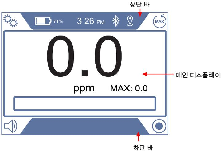
**상단 표시줄:** 상단 표시줄에는 배터리 기호와 충전량(%), 시간, GPS, 블루투스 상태가 포함되어 있습니다.
