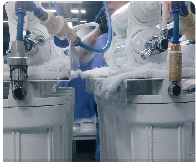
检测区积压的设备在用肥皂水检漏后需要烘干。
